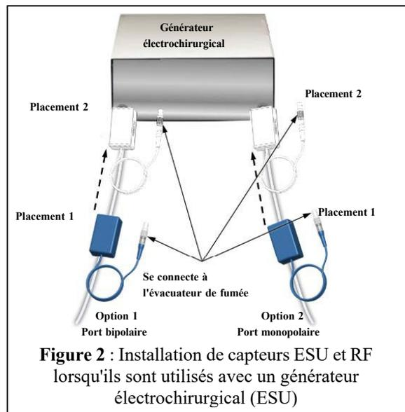
**Figure 2 :** Installation de capteurs ESU et RF lorsqu'ils sont utilisés avec un générateur électrochirurgical (ESU)
