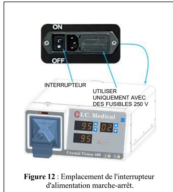
Figure 12 : Emplacement de l'interrupteur d'alimentation marche-arrêt.
