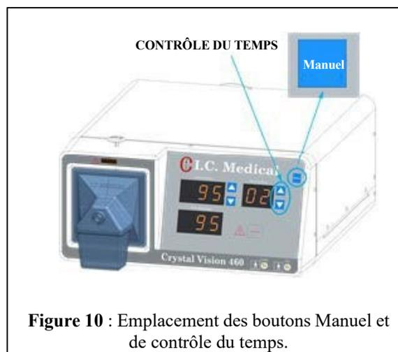
Figure 10 : Emplacement des boutons Manuel et de contrôle du temps.
