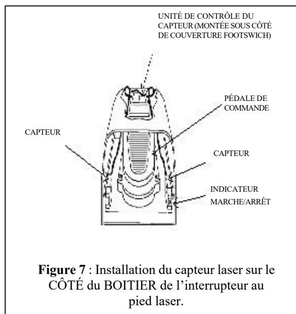
**Figure 7 :** Installation du capteur laser sur le CÔTÉ du BOITIER de l'interrupteur au pied laser.
