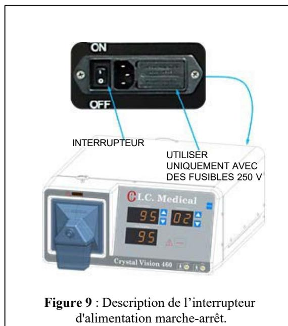
Figure 9 : Description de l'interrupteur d'alimentation marche-arrêt.
