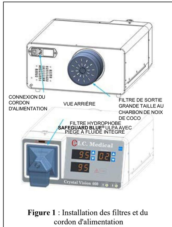
**Figure 1 :** Installation des filtres et du cordon d'alimentation
